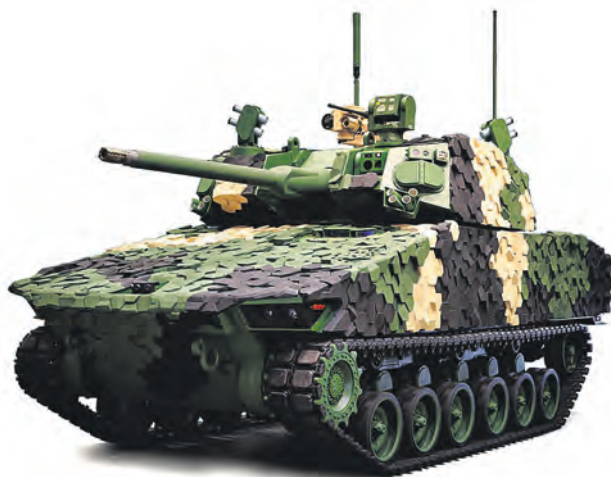
Эскизный образец легкого танка «Гриффин-3» с 50-мм пушкой, системой активной защиты и специальным камуфляжным покрытием
