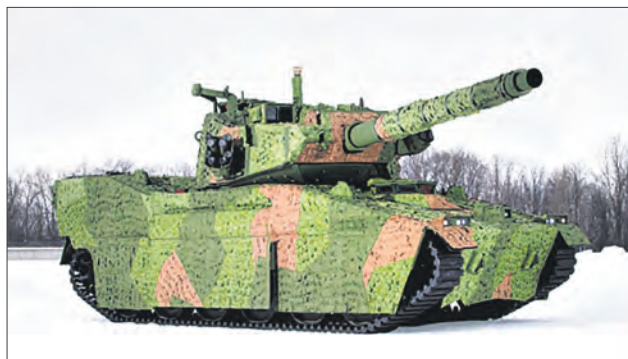
Опытный образец легкого танка со 120-мм пушкой, навесной броней и камуфляжным комплектом
