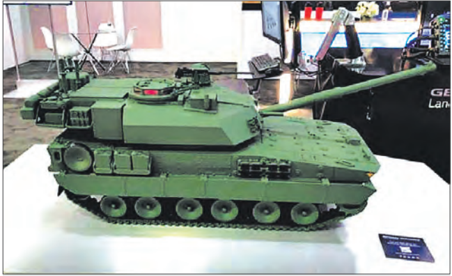
Модель легкого танка со 120-мм пушкой и навесной броней
