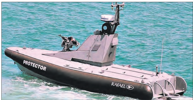
Безэкипажный катер «Протектор» с дистанционно управляемым пулеметом
