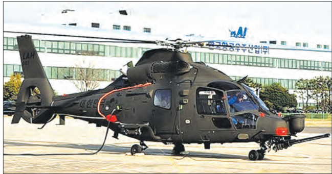
Южнокорейский легкий вертолет LAH, вооружен 20-мм автоматической пушкой и 70-мм неуправляемыми авиационными ракетами
